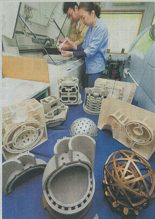
鋳型製造に3Dプリンターを活用する小松鋳型製作所。耐熱性の高い材料で特許を取得した
